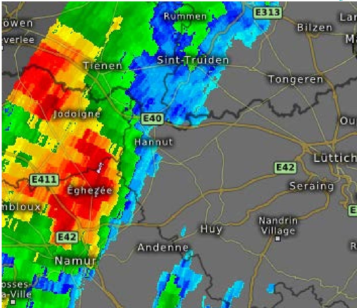
Imagerie de réflectivité A 21h30. La faible réflectivité dans la région de Jodoigne semble indiquer la présence d'une couche d'air sec qui provoque l'évaporation de l'eau dans les couches moyennes. Source : Kachelman.
