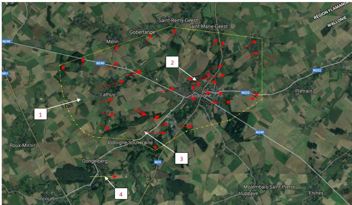
Image satellite de la région de Jodoigne (source : Google Maps). Légende : lignes jaunes : limite de la rafale descendante. Flèches rouges : orientation des dégâts.
